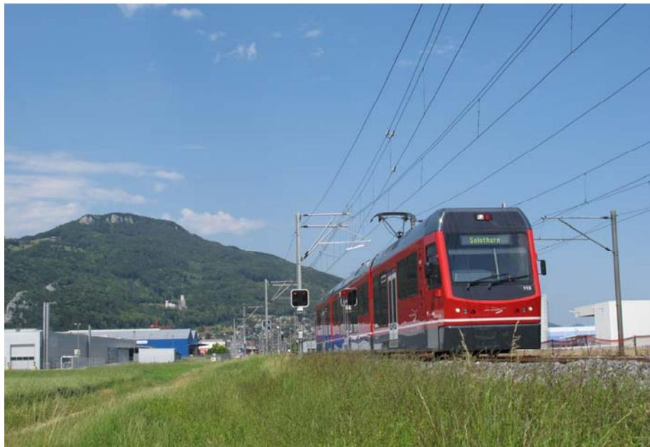
*Véhicule à plancher surbaissé de type STAR Be 4/8 (photo de couverture, source: Aare Seeland mobil AG)*
