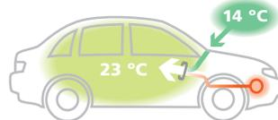
Aussenluft (z.B. 14°C) wird bis zu 3°C abgekühlt. Das verbraucht ca. 5% Benzin (2,5% Diesel). Erst dann wird die Luft wieder auf die gewünschte Innentemperatur (ideal 23°C) aufgeheizt.
