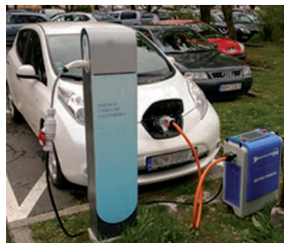
Figure 5 : un point de recharge AC de 220kW ne peut être utilisé à pleine puissance qu'avec un convertisseur AC/DC mobile (à l'exception de la Renault ZOE, aucune autre voiture ne possède un chargeur intégré à bord à 22kW avec entrée AC).
