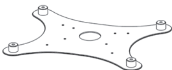
Figure 52 : exemple de plaque de fixation avec ancrages pour arceaux de protection, solution utile lorsqu'il n'est pas possible d'utiliser un socle.
