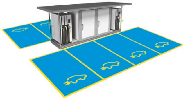
Figure 47 : exemple d'aménagement d'une possible future station de recharge de véhicules électriques sur une aire d'autoroute avec 4 bornes de type "parallèle" et un système de stockage central.
