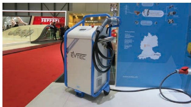
Figure 50: exemple de borne de recharge mobile.
