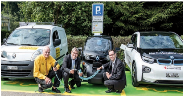
Figure 34 : un bon exemple de borne "Totem" qui alimente simultanément 2 voitures et un motorcycle/quadricycle (aménagement d.2, Figure 33).
