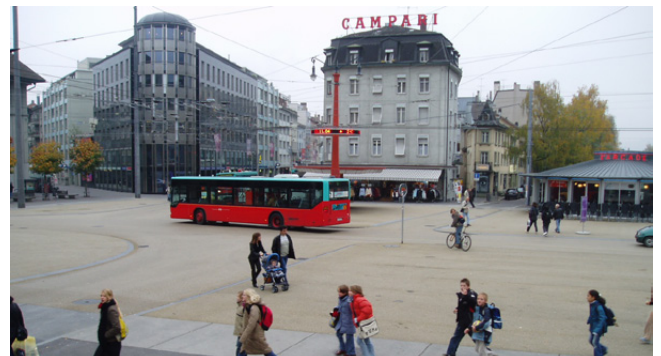
III. 6: Zone de rencontre sur la place Centrale (vieille ville) à Bienne. Ce sont environ 1'200 bus et 8'000 véhicules motorisés qui traversent la zone de rencontre chaque jour dans un climat de respect mutuel qui s'est installé au fil du temps. Une bordure biaisée en pierre de couleur grise délimite la chaussée des surfaces destinées aux piétons.
