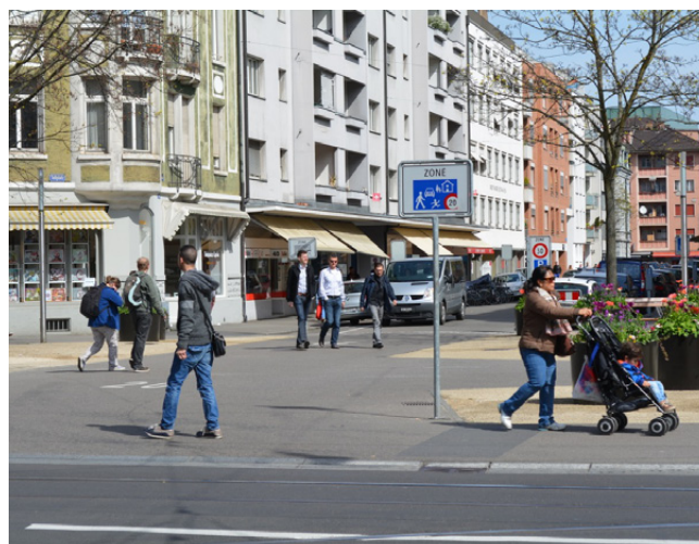
Abb. 1: Begegnungszone Quartierzentrum Tellplatz Basel: Entlang einer wichtigen Quartierachse wurde ein grosszügiger Einmündungsbereich mehrerer Erschliessungsstrassen als Begegnungszone ausgestaltet. Dienstleistungsbetriebe und Quartierläden in den Erdgeschoss und die nahegelegene Tramhaltestelle sorgen für regen Fussverkehr.
